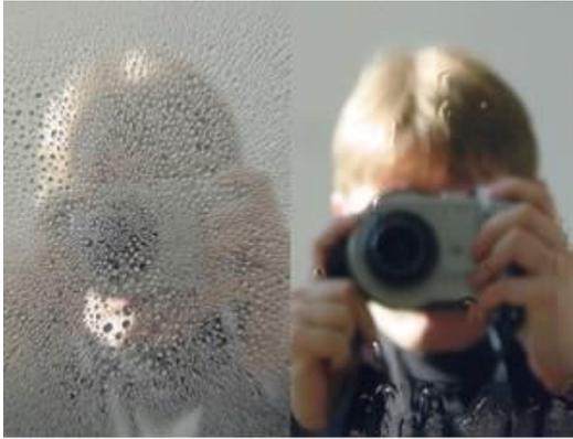
Superhydrophile Titandioxid-Schicht (rechts) als easy-to-clean Beschichtung © Fraunhofer FEP
